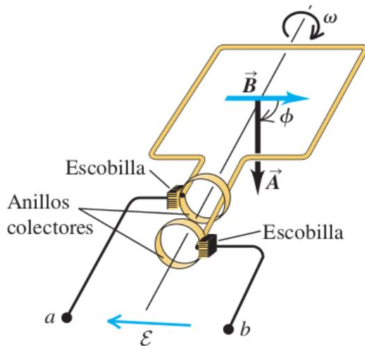
Transformo energía mecánica en energía eléctrica
