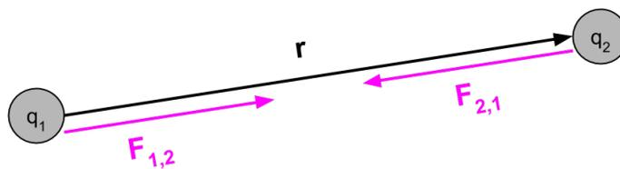
**Figura 1:** Sistema de dos cargas  $q_1$  y  $q_2$  a una distancia  $r$ , con la esquematización de las fuerzas eléctricas en ambas cargas.
