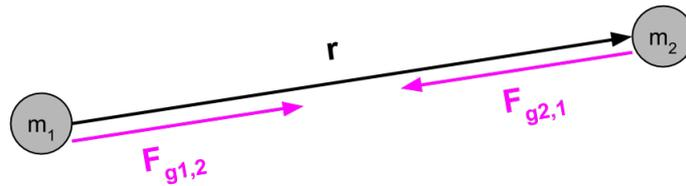
**Figura 2:** Sistema con dos masas y sus atracciones gravitatorias.
