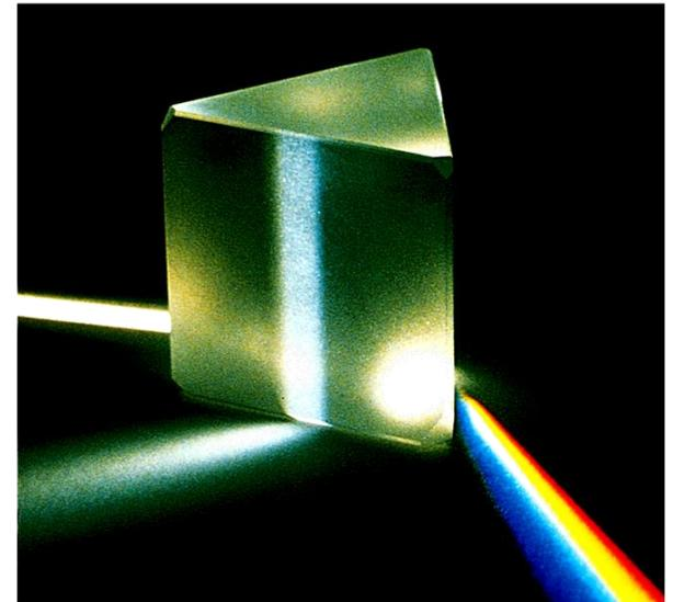
*La desviación (cambio de dirección) producida por el prisma aumenta al incrementarse el índice de refracción y la frecuencia y al disminuir la longitud de onda.*
