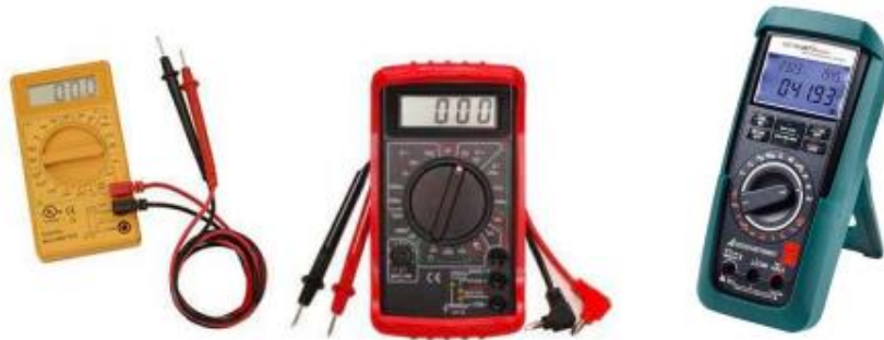
Figura 1.1: Ejemplos de multímetros digitales. Se destacan: la pantalla, llave selectora, bornes de entrada y puntas de prueba.
